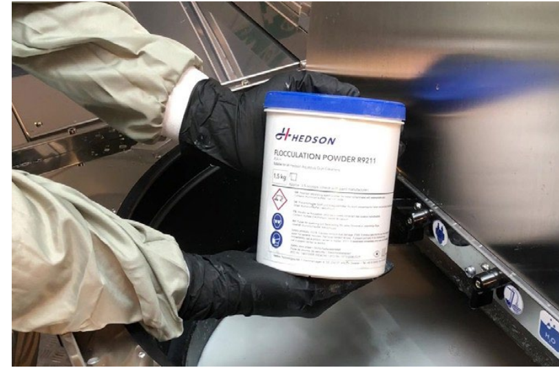
응고 파우더 품번. 9211 (1 개 1.5 kg) 수용성 페인트 잔여물과 물을 분리시킵니다.
